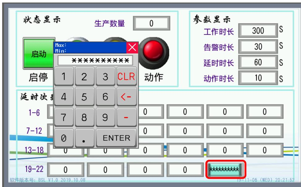
点击密码按钮，弹出数字键盘，输入密码，出现“参数设置”按钮。
